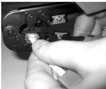
10.8-rasm. Ish quroli yordamida konnektorni siqish.
