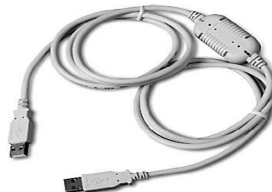
9.2-rasm. Ikki komp'yuterni ulashda ishlatiladigan USB kabeli.
