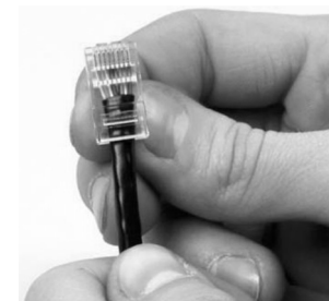
10.7-rasm. O'tkazgichlarni konnektorga joylash.
