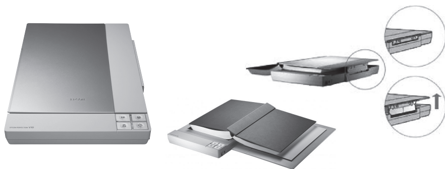
4.16-rasm. Skanerning tashqi ko‘rinishi va qopqog‘ini qotirish konstruksiyasi.
